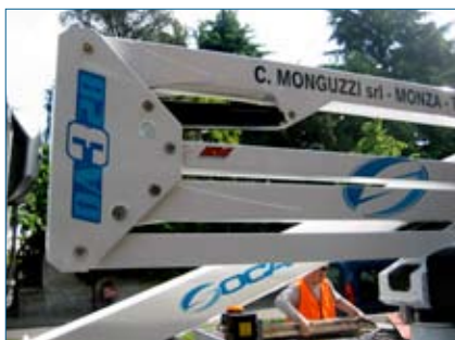
Alcune prerogative fondamentali della DA328 di Socage: esclusivo sistema Easy Lift per un impiego indipendente degli stabilizzatori, centralina di controllo delle funzioni elettroidrauliche, doppio pantografo a martinetto unico
