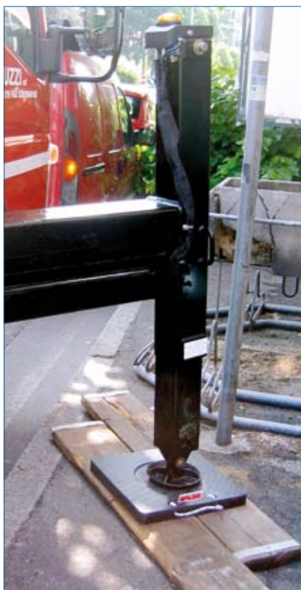
Alcune prerogative fondamentali della DA328 di Socage: esclusivo sistema Easy Lift per un impiego indipendente degli stabilizzatori, centralina di controllo delle funzioni elettroidrauliche, doppio pantografo a martinetto unico
