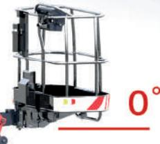
Il sistema SPS permette l'utilizzo dei Billionium Spiderboom anche senza abbassare gli stabilizzatori, livellando longitudinalmente fino ad un massimo di 10° con un'altezza massima di lavoro di 8 m per il B1570 ETS e 9 m per il B1890 (pendenza laterale max 5°).
