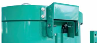
Dispositivo elettrico di sicurezza che blocca la rotazione delle pale di mescolamento in modo automatico quando viene alzata la griglia I-DUST.
