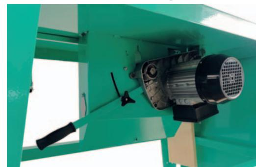
H110VR PLUS è dotata di leva per la regolazione dell'altezza di taglio da 0 a 110 mm.
