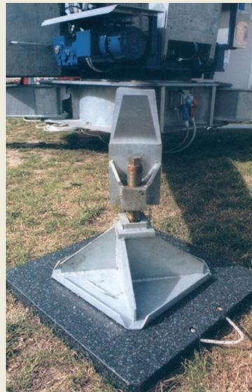
Per conferire stabilità alla piattaforma aerea, sotto ai suoi piedi d'appoggio vengono generalmente posti dei basamenti in legno. Si tratta di un materiale comunque deformabile se sottoposto a carichi elevati, che con il tempo tende inesorabilmente a degradarsi. La Ormi di Graziano Guidetti distribuisce dei supporti in materiale plastico, denominati *King Pads*, realizzati in truciolato
