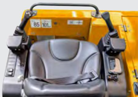
I comandi sono interamente servo-assistiti con joy-stick montati sui braccioli del sedile, ruotante di 180° per mantenere l'operatore sempre orientato nella direzione di marcia del mezzo.
